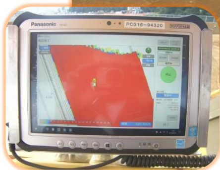
GNSSを用いた転圧
